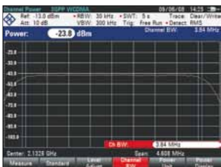
Измерение мощности в канале
