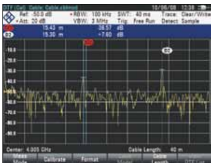
Измерение расстояния до места повреждения (DTF)
