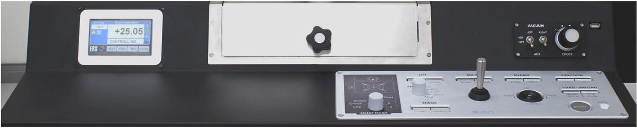
Управление термическими держателями осуществляется с интегрированного сенсорного дисплея, расположенного непосредственно перед оператором для быстрого выполнения команд и своевременного реагирования.
