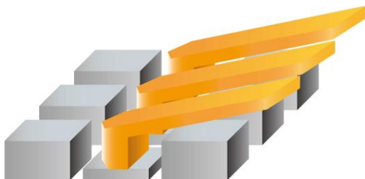
Уникальная конструкция копланарного МЭМС-контактного наконечника зонда TITAN™.
