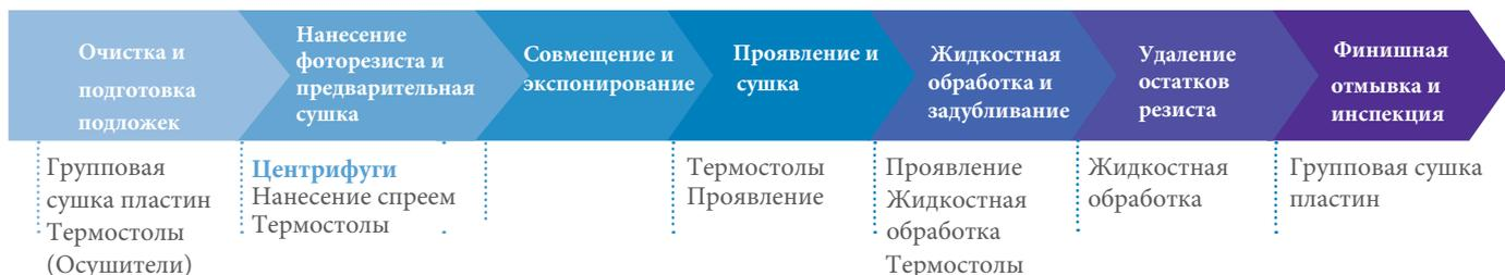
**Центрифуга SM-150** является оптимальным выбором для задач ручного и полуавтоматического нанесения тонких пленок. Обычно подобные системы используют для нанесения фоторезистов и полимеров на чистые пластины с невысоким профилем топологии. Одинаково хорошо наносятся все широко известные типы и марки фоторезистов на круглые пластины диаметром до 150мм (6 дюймов) и прямоугольные подложки габаритами до 127x127 мм (5 на 5 дюймов) с гарантированной повторяемостью и высокой равномерностью.
