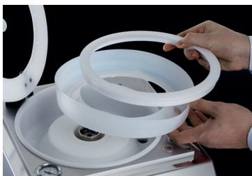
Для того, чтобы максимально сократить затраты на очистку для технологической камеры, SAWATEC разработала универсальное решение для защиты чаши. Эту защитную вставку легко удалить и утилизировать по завершении процесса. Благодаря конструкции высокого качества затраты на обслуживание минимальны, поэтому центрифуги SAWATEC используются для лабораторий, НИОКР, пилотных проектов и институтов.
