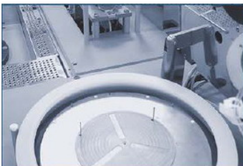
Модуль нанесения с обработчиком края и обмывом задней стороны пластины
