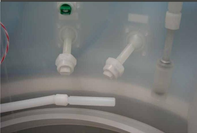
Система финальной промывки деионизированной водой и веерные форсунки для процессов травления/проявления. Для исключительной чистоты пластин перед сушкой
