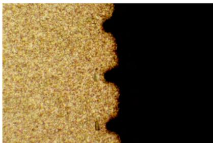
Рисунок 5. Изображение следов головки не параллельных поверхности
