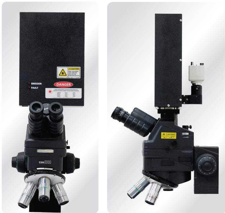
Лазерный резчик CLS-635 с микроскопом MOTIC PSM-1000
